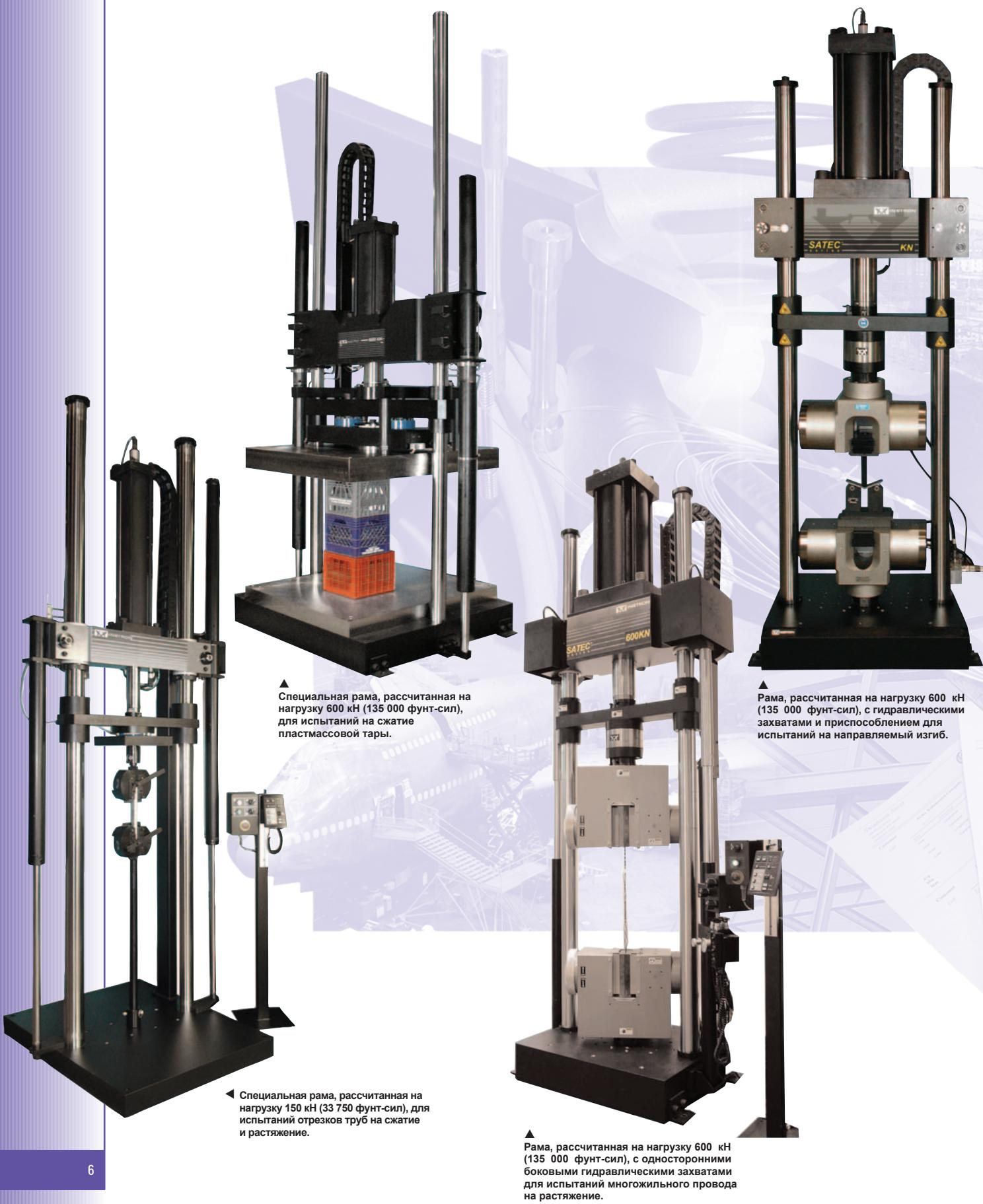
▲ Специальная рама, рассчитанная на нагрузку 600 кН (135 000 фунт-сил), для испытаний на сжатие пластимассовой тары.
