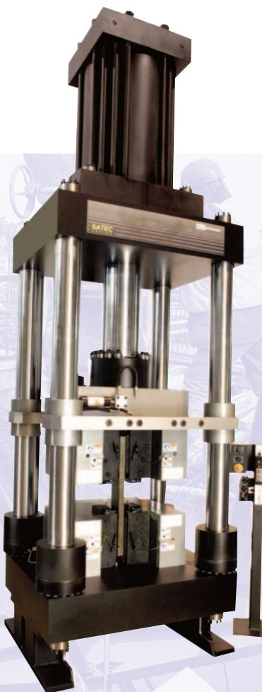
▲ Специальная рама, рассчитанная на нагрузку 3 500 кН (800 000 фунт-сил) для испытаний на растяжение арматуры большого диаметра.
