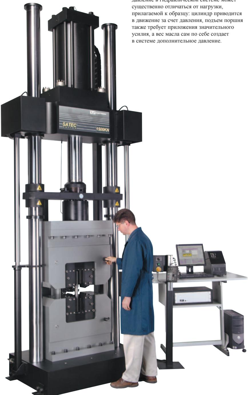
▲ Рама с гидравлическими клиновыми рабочими захватами для испытания металлов, рассчитанная на нагрузку 1500 кН.
