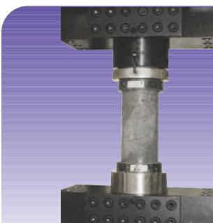
Плиты сжатия на сферическом подшипнике или обычные
