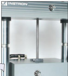
Имеются встроенные захваты, находящиеся в V-образном пазу, или плоские пластины для испытания таких образцов, как пруток, труба, лист и провод.
