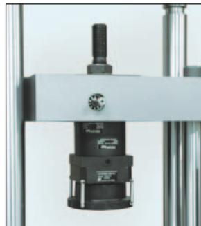
Мост с тягой для испытаний на сжатие позволяет устанавливать фиксаторы для испытаний на сжатие и изгиб в нижнем рабочем пространстве машины без снятия сферических тяг.
