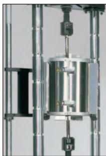
Печи и крепежные приспособления можно устанавливать на испытуемые материалы и при повышенных температурах.
