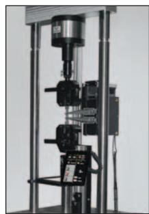
Легкость доступа к рабочему пространству идеальна для автоматических экстензометров.
