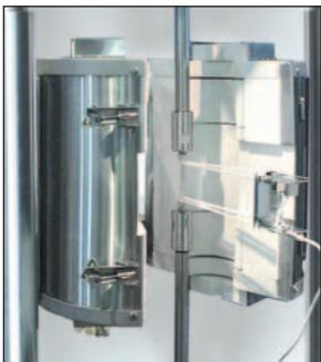
Печи и крепежные приспособления можно устанавливать на испытуемые материалы и при повышенных температурах.
