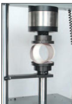
▲ Фиксатор для испытаний на сдвиг может быть адаптирован для испытания крепежных деталей, арматуры и компонентов.
