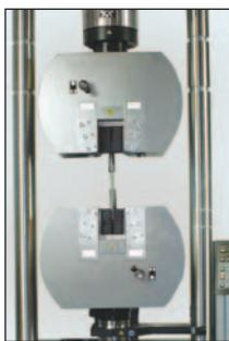
В большом рабочем пространстве помещаются фиксаторы для больших образцов.
